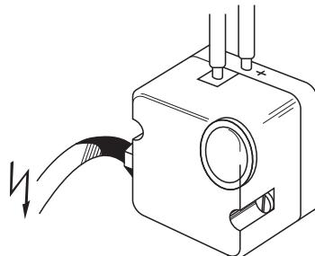
ABB. 15: Differenzdruckschalter zur Filterüberwachung
