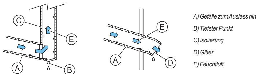
ABB. 9: Montage des Fortluftkanals für Feuchtluft
