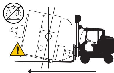
ABB. 8: Vorsicht beim Heben und Transport des Geräts
