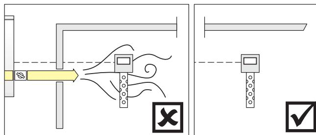
ABB. 10: Installationsposition Hygrostat
