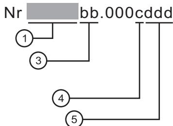
ABB. 2: Aufbau der Seriennummer für einphasige Anlage
