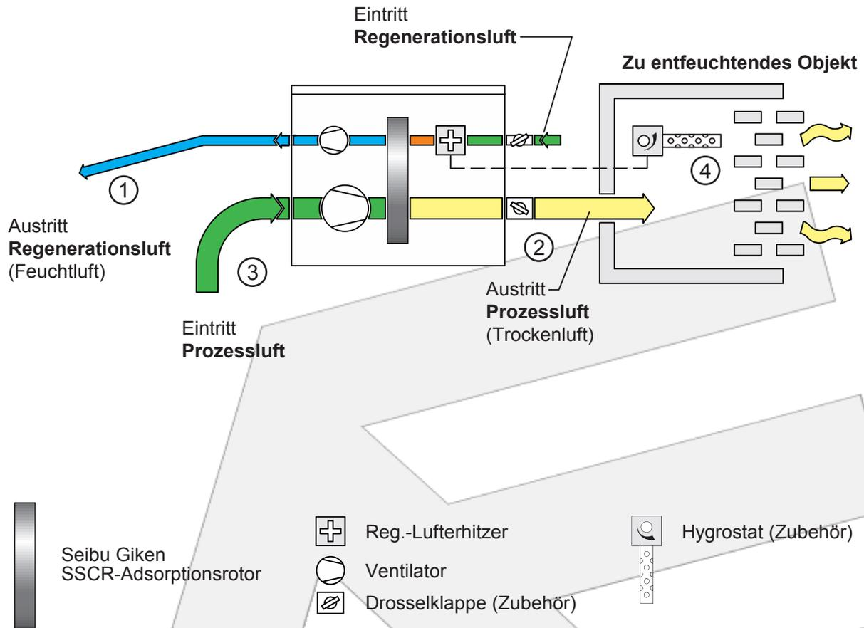
Die dargestellte Lage der Drosselklappen entspricht der Position in der Realität. Bei der Frischlufttrocknung sind die lokalen Leitungsdruckverhältnisse für die Platzierung der Drosselklappen unerheblich.
