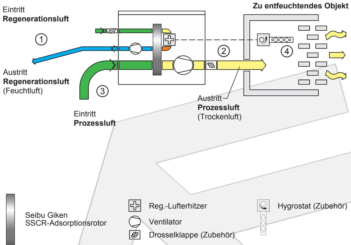
Die dargestellte Lage der Drosselklappen entspricht der Position in der Realität. Bei der Frischlufttrocknung sind die lokalen Leitungsdruckverhältnisse für die Platzierung der Drosselklappen unerheblich.
