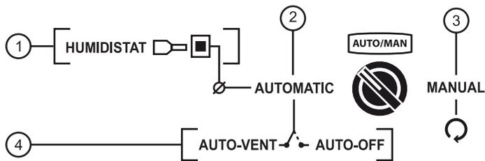
1. Anbindung eines Hygrostat- für die Regelung der Entfeuchtung.
