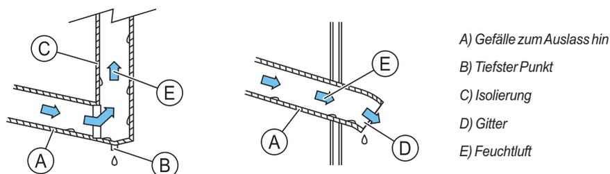
ABB. 9: Montage des Fortluftkanals für Feuchtluft
