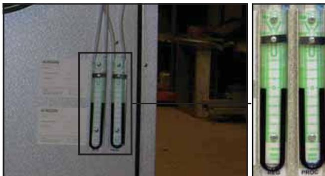
Abb. 7: Beispiel zum Aufbau eines U-Rohr-Filtermanometers
